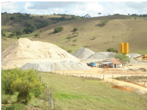
Foto 3 - Estocagem de areia e brita, com usinas misturadores de concreto e argamassa.
